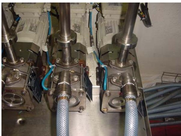
Ce sont ces cuves de plus faibles contenances qui permettront d'alimenter les machines de remplissage et de conditionnement des flacons de parfums. Les pompes EX20 sont réversibles et permettent ainsi de récupérer les essences de parfum lorsqu'elles n'ont pas été conditionnées. Le moteur tourne alors simplement en sens inverse. Elles offrent, en outre, la haute résistance aux fluides agressifs de l'Inox 316 L massif.
