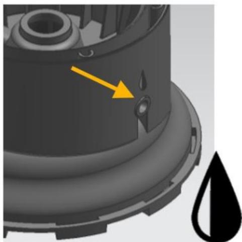
Légende : Bouchon sur l'arrière pour le contrôle de l'huile
