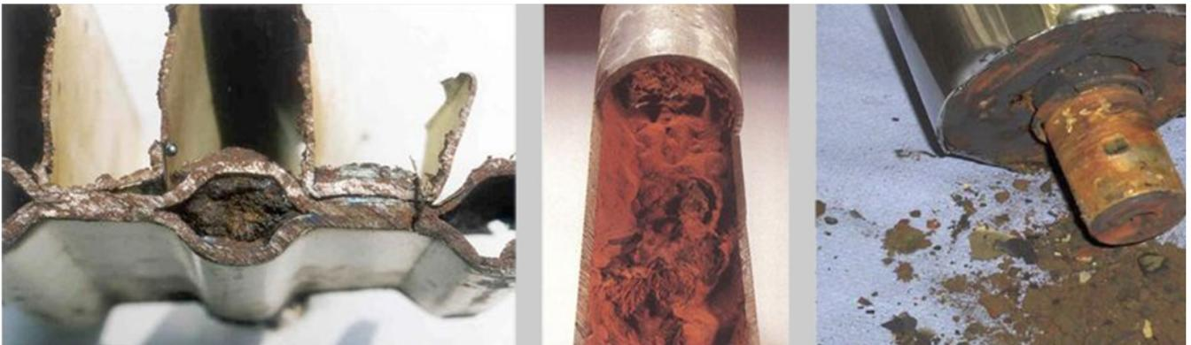
Pour remédier à ce problème, une solution consiste à transformer et à maintenir cette eau chargée en eau claire grâce à une solution de désembouage.
