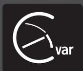
La regolazione  $\Delta PV$  permette di variare proporzionalmente la pressione differenziale in impianto, al variare della portata, garantendo metà della pressione di funzionamento a portata nulla rispetto al valore di pressione impostato. **È ideale in impianti in cui le perdite di carico localizzate sono molto più grandi delle perdite di carico degli utilizzatori** (Fancoil, Termosifoni, ecc.) come gli impianti di nuova concezione, gli impianti radianti a pavimento, ecc.
