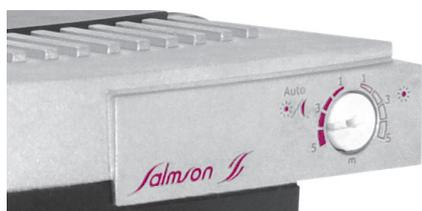
La scala da 1 a 3 (Siriux Jr 3m) e da 1 a 5 (Siriux Jr 5m) indicano la prevalenza in m.c.a., ogni posizione intermedia è possibile.
