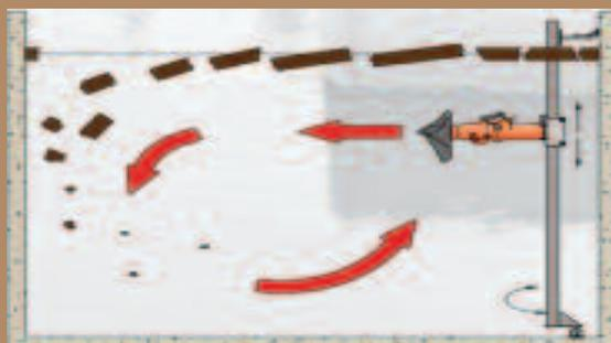
L'agitation moyenne vitesse permet d'éviter la formation d'une couche solide de boues en surface en cassant la croûte supérieure.
