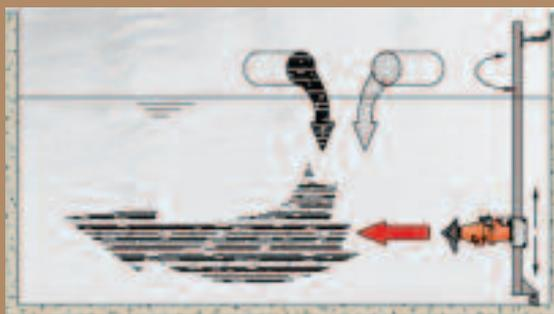
L'agitation rapide permet de brasser correctement le mélange et d'optimiser l'homogénéisation des fluides
