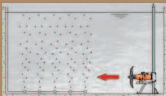
La combinaison de l'aération fines bulles et l'agitation lente permet d'augmenter le taux de transfert d'oxygène dans l'eau
