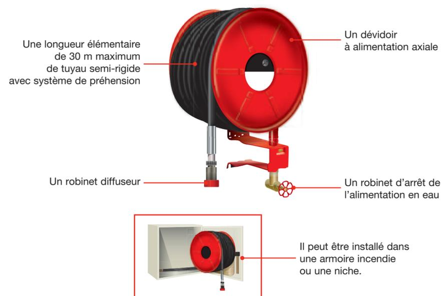
Les installations de Robinets d'Incendie Armés (R.I.A.) sont conçues pour permettre une première intervention d'urgence manuelle dans la lutte contre l'incendie, en attendant que des moyens plus puissants soient mis en œuvre. Il est dit armé car il est alimenté en permanence par une source d'eau, et est prêt à l'emploi.
