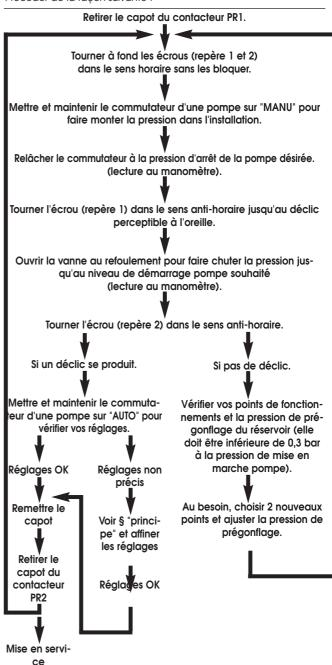
Nota : Les points hauts (pression - arrêt) des deux pompes sont identiques. Les points bas (pression - marche) sont à décaler de 0.5 bar. Pf de PR2 < 0.5 Pf de PR1.
